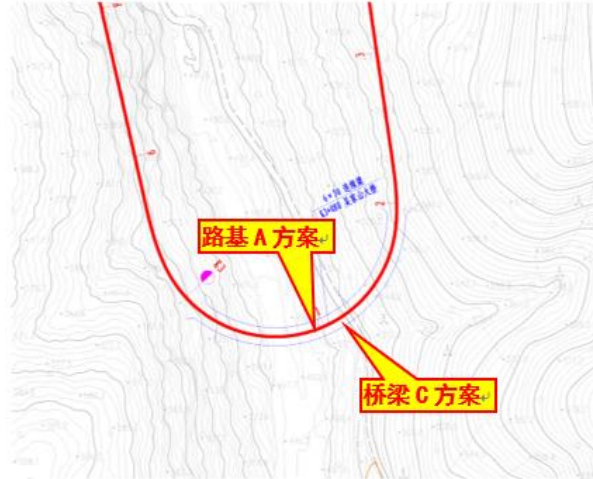
图 3.2-3 桥梁 C 方案与 K 线路基 A 方案比选
