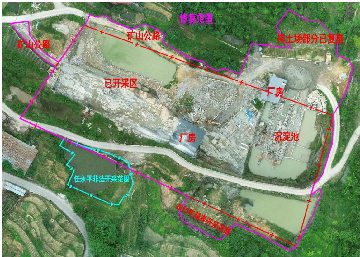
图 3.1 矿山损毁现状图
